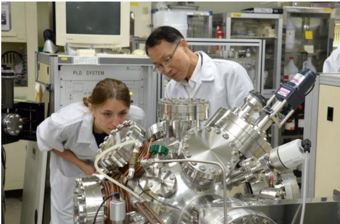
▲ Si 기판 위에 MIT 박막을 증착 중인 김현탁 박사(오른쪽)와 테티아나 연구원. ©ETRI
